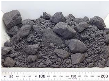
粒度調整砕石30-0（サイズ30~0mm）
