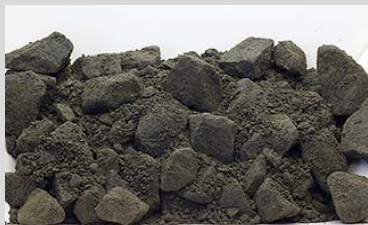
粒度調整砕石 (サイズ30~0mm)
