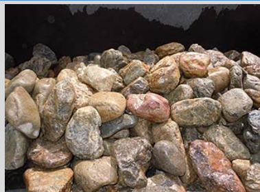
大きさ 10cm内外、重さ 約3kg 砂利30-20（サイズ30～20mm）
