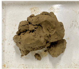
写真-1 脱水ケーキの外観
