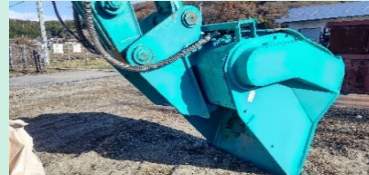
ミキシングバケットによる二次攪拌
